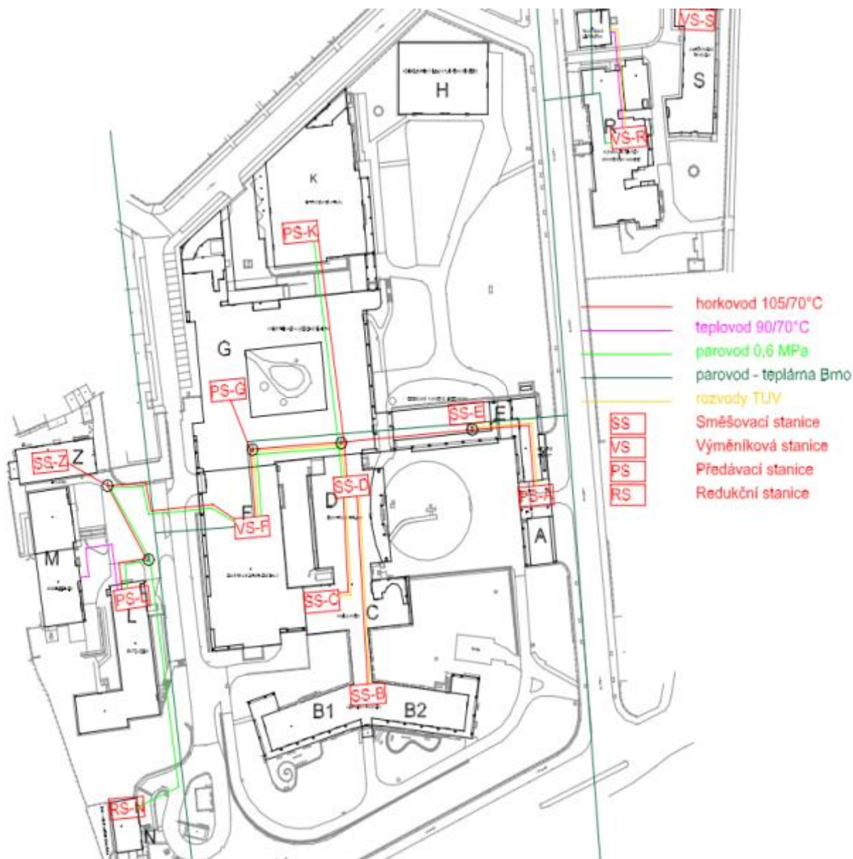
Obrázek 11 – Zjednodušené schéma distribučního systému tepelné energie (zdroj: Zpráva o energetickém auditu – PDM FN Brno, zpracovatel: SEVEN Energy s.r.o. 12/2019)
